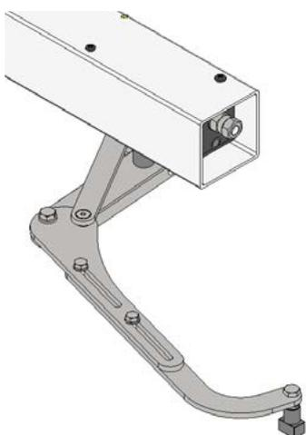
**ST40:** La storica motorizzazione Chiaroscuro: vanta un movimento del braccetto brevettato che consente ingombri ridottissimi di soli 60mm.
