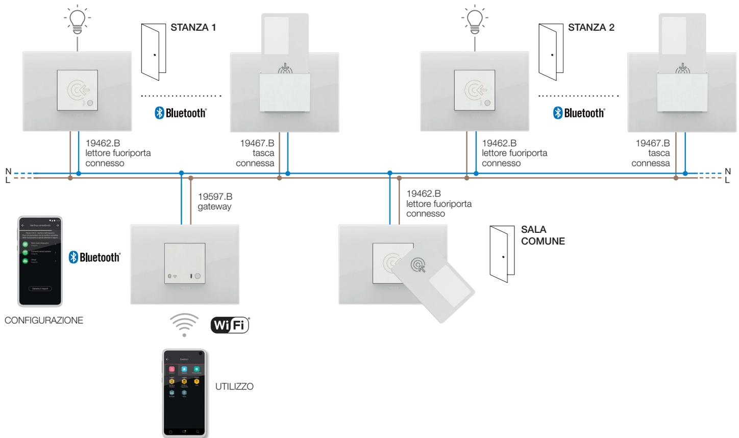
Esempio architettura del sistema View Wireless con dispositivi da incasso e standard Zigbee technology:
